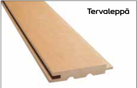
Kallio 15x90 | Hyötyleveys: 77 mm | Menekki neliölle: 13 m | Paketissa: 6 kpl
