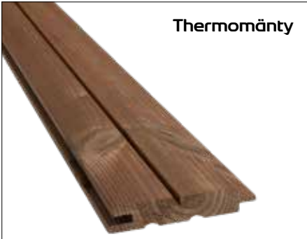
Kallio 1 -valeura 15x90 | Hyötyleveys: 77 mm | Menekki neliölle: 13 m | Paketissa: 6 kpl *Kallio 1 -valeura 17x90 | Hyötyleveys: 77 mm | Menekki neliölle: 13 m | Paketissa: 5 kpl
