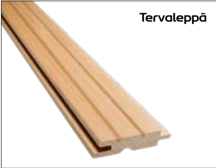
Kallio 2 -valeura 15x70 | Hyötyleveys: 57 mm | Menekki neliölle: 17,5 m | Paketissa: 6 kpl
