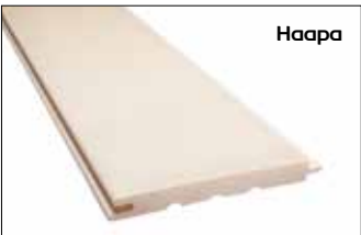
Kallio 15x140 | Hyötyleveys: 127 mm | Menekki neliölle: 7,9 m | Paketissa: 6 kpl
