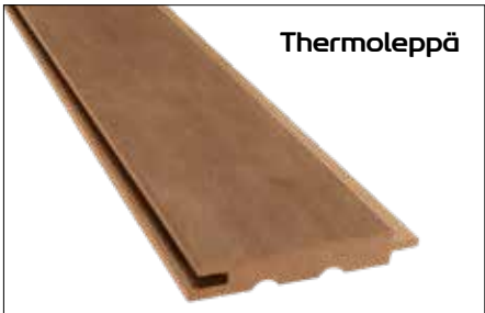
Kallio 15x90 | Hyötyleveys: 77 mm | Menekki neliölle: 13 m | Paketissa: 6 kpl
