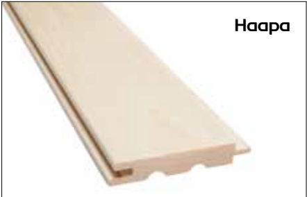
Kallio 15x90 | Hyötyleveys: 77 mm | Menekki neliölle: 13 m | Paketissa: 6 kpl
