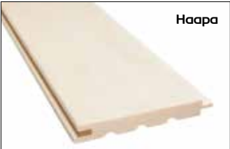
Kallio 15x120 | Hyötyleveys: 107 mm | Menekki neliölle: 9,4 m | Paketissa: 6 kpl
