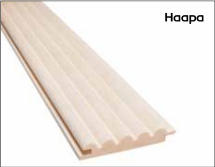
Sormipaneeli 15x90 | Hyötyleveys: 79 mm | Menekki neliölle: 12,7 m | Paketissa: 6 kpl
